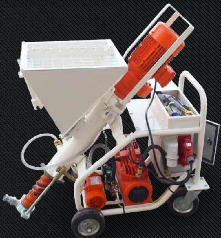
**Máquina dotada con bomba excéntrica (camisa-sinfín) para el bombeo y proyección de materiales premezclados.**
